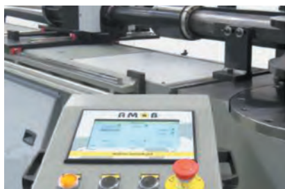
Удобное сенсорное управление Станки MDH Series оснащаются цифровой сенсорной панелью управления.
