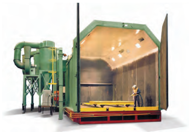
Камера ручной дробеструйной обработки крупногабаритных изделий
