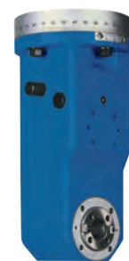
Угловая фрезерная голова BT50/L500/90° с макс. скоростью 3500 об/мин, угловой шаг 5° (EA)
