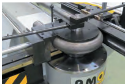
Цилиндр заднего прижима Цилиндр заднего прижима установлен на уровень центр. линии для снижения нагрузок.
