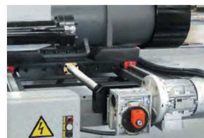
Моторизир. настройка инструмента Оptionальная моторизированная настройка инструмента на станках серии CH-HD.
