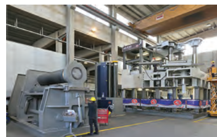
Уникальная технология производства станков для гибки листа толщиной до 260 мм
