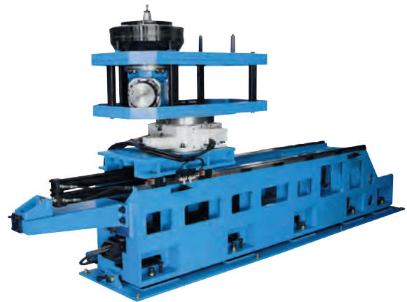
Автоматический сменщик фрезерных головок 2-позиционный
