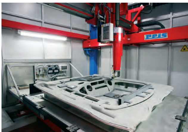
Портальная система для резки газовым лазером габаритных 3D деталей
