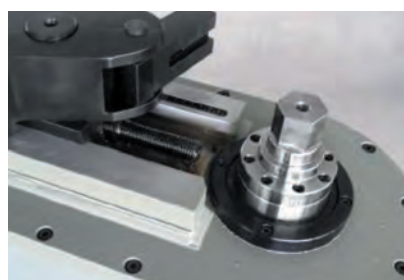
Взаимозаменяемый вал Станки PT серий оборудованы заменяемым валом для малых радиусов.
