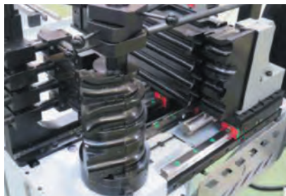
Многоуровневая оснастка Все модели eMOB с многоуровневым инструментом для фиксир. и перемен. радиуса.
