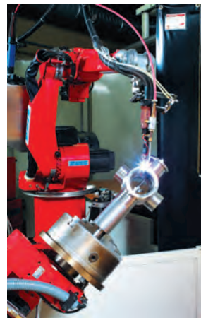
Роботизированная MIG/MAG сварка деталей любой сложности
