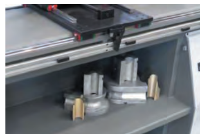
Встроенный инструментальный шкаф Станки MDH оснащены встроенным шкафом для хранения оснастки и принадлежностей.
