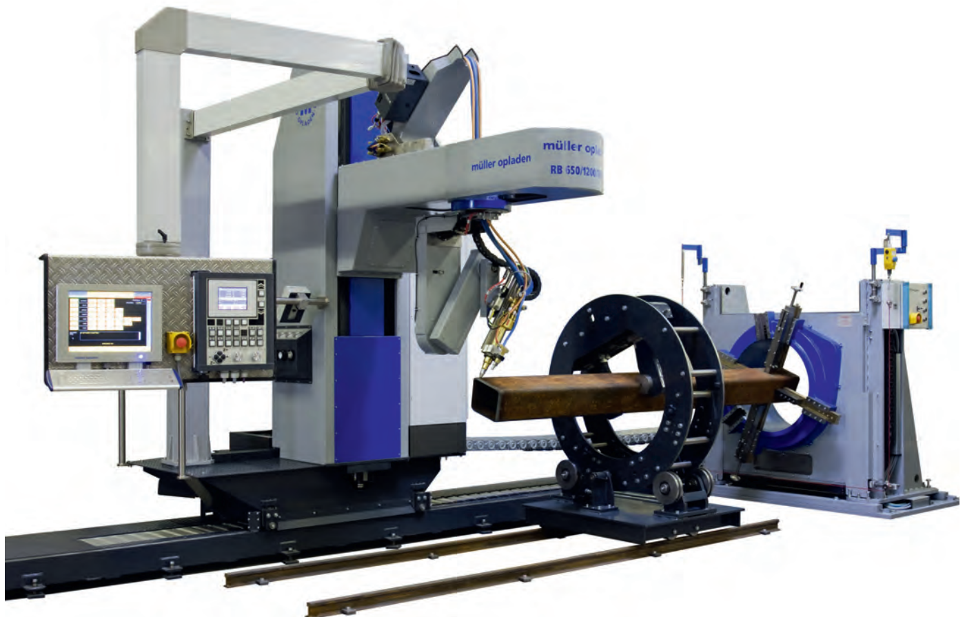
RB 650/1200/7 Classic с 7 ЧПУ осями, с автогенной режущей системой для труб, полого профиля и стальных балок
