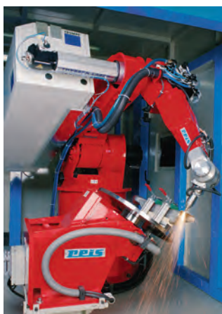
Лазерный источник расположен на 2-й подвижной оси антропоморфного робота
