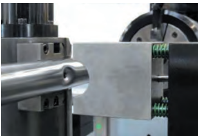
Пробивной узел Добавление пробивного узла в станки eMOB по запросу.
