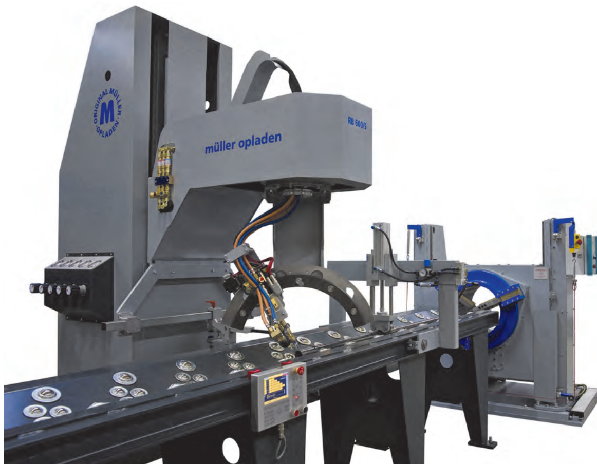
RB 800/5 compact с 5 ЧПУ осями, плазмотроном Kjellberg PA-S 45W, автогенной системой, с переставляемым по высоте зажимным патроном, с рольгангом и прижимом для труб с максимальным диаметром 812 мм СТР12 (SEITE 12)
