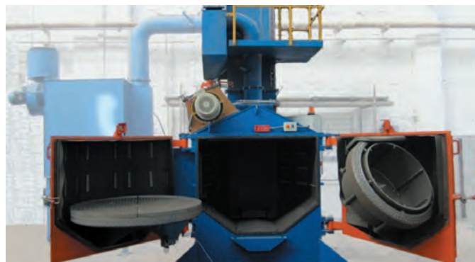
Установка Duplex может оснащаться одним или двумя столами, или столом и барабаном.
