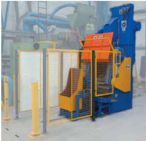
ALJUBAN - дробеметная установка контейнерного типа с конвейерной лентой
