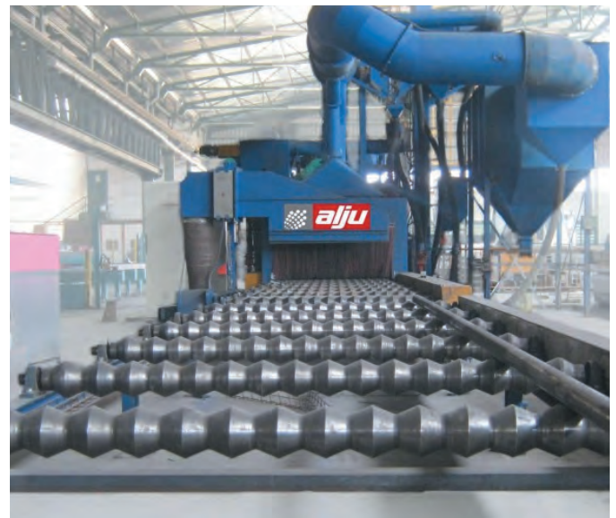
Линия дробеметной обработки модели 155 для обработки профилей и листов
