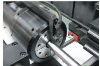
Обнаружение сварного шва Опциональное добавление узла обнаружения сварного шва.
