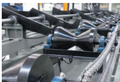
Задняя и передняя загрузка труб Оptionальная интегрированная система загрузки/выгрузки труб.
