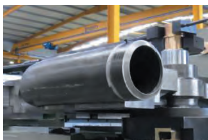
Быстрая смена инструмента Быстрая смена инструмента серии CH-HD снижает время наладки.
