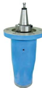
Вертикальная фрезерная голова BT50/L500 с макс. скоростью 3500 об/мин, угловой шаг 5° (EH)
