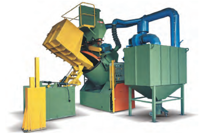
TAMBRO – дробеметная установка контейнерного типа с непрерывно вращающимся металлическим барабаном
