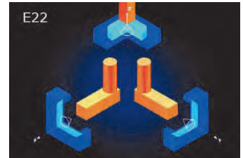
Перемещения электрода по осям X, Y и Z в 6 рабочих плоскостях
