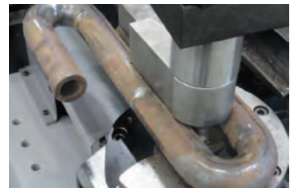
Гибка змеевиков Разработан для выполнения серии гибов, которые требуют угол на 180 градусов.
