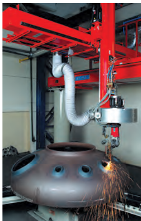
Сварка габаритных деталей с использованием роботизированной консоли RLV03-123
