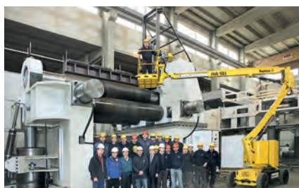
Уникальная технология производства станков для гибки листа толщиной до 260 мм
