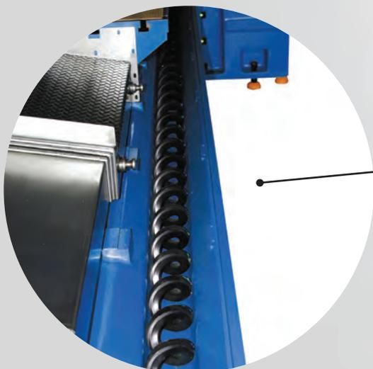
Шнековый стружкоуборочный транспортер с каждой из двух сторон.
