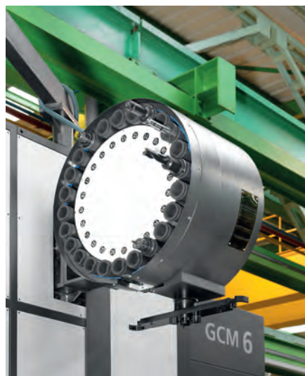
Drum type Automatic tool changer УАСИ барабанного типа
