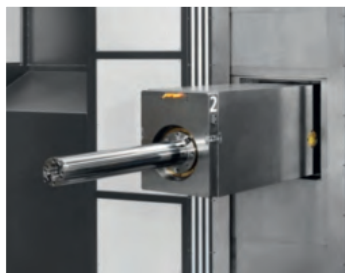
Hydraulic compensation for ram Система гидравлической компенсации прогиба стрелы
