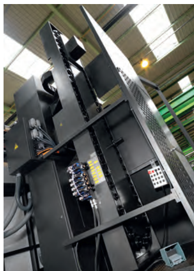
Chain type ATC 40 or 60 tools УАСИ цепного типа на 40 или 60 инструментов
