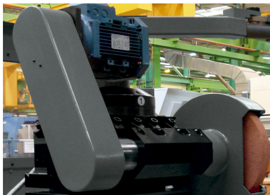
Устройство шлифования, устанавливаемое на револьверную головку или вместо нее
