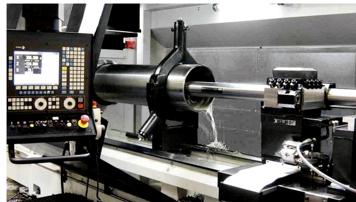
Устройство для глубокой расточки, устанавливаемое либо на поперечный суппорт станка, либо на револьверную головку, либо вместо головки
