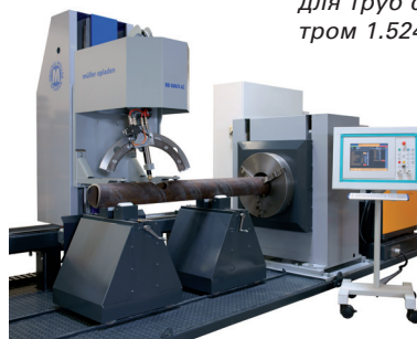
RB 600/5 compact с 5 ЧПУ осями для труб с максимальным диаметром 610 мм
