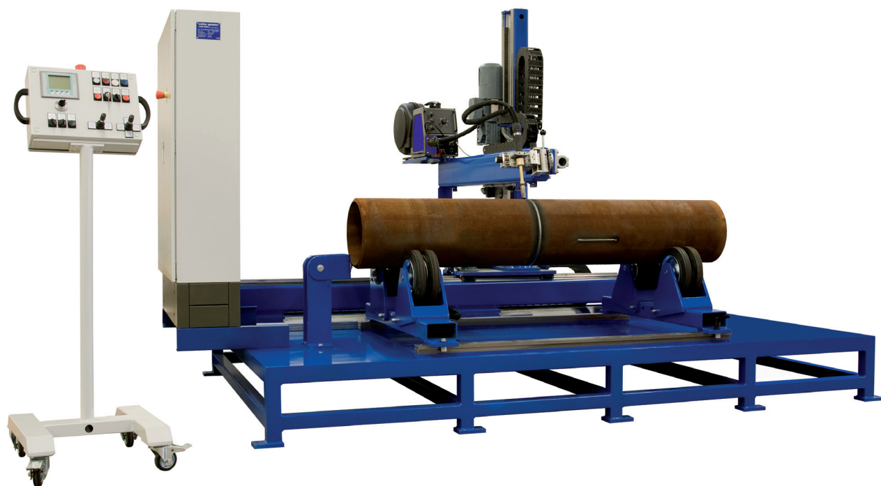
Поворотное поддерживающее устройство для емкостей с автоматической сварочной кареткой для сварки кольцевых и продольных швов цилиндрических заготовок
