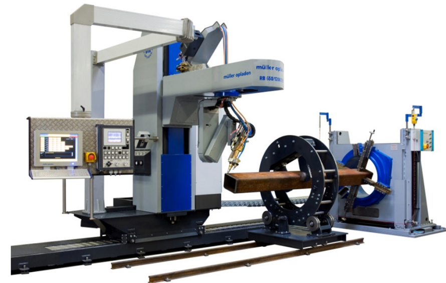
Машина для \varnothing 1.200 мм или 420 мм x 420 мм, обработка круглой трубы, полового профиля или некоторых видов балки
