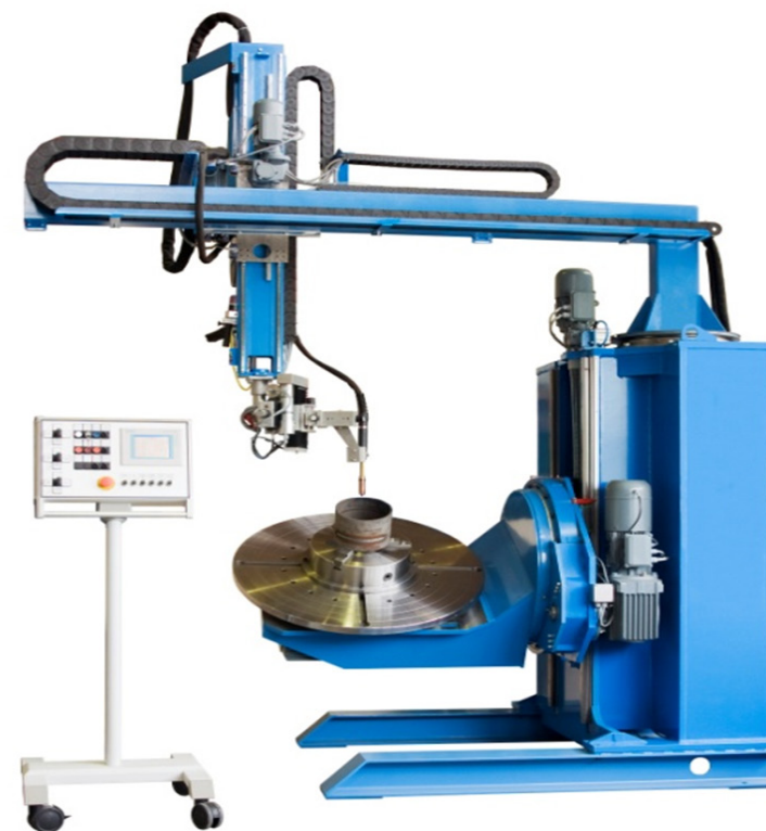
Автоматический многоосевой позиционирующий стол с интегрированной колонной для MIG/MAG-сварки различных деталей
