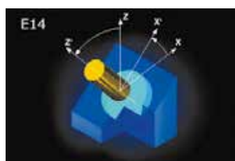
Орбитальные перемещения электрода по нормали к поверхности детали, наклоненной до 45°
