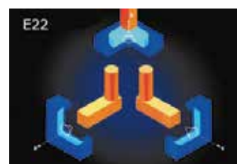
Перемещения электрода по осям X, Y и Z в 6 рабочих плоскостях
