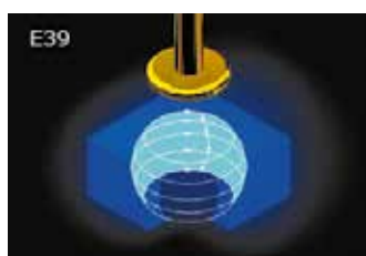
Перемещения электрода с постоянной координатой по оси Z и одновременными перемещениями по осям X и Y. В том числе и по круговой интерполяции (внутренние, поднутренные поверхности)
